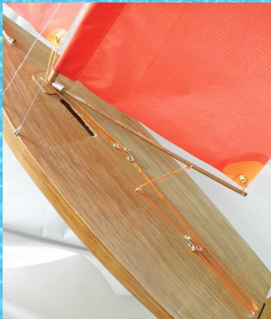
Les écoutes de foc et de grand voile sont montées avec des petits tendeurs métalliques qui vous permettent choquer (allonger) ou de border (raccourcir) les écoutes. En bordant l'écoute on ferme la voile dans l'axe du bateau. En choquant on ouvre la voile.
